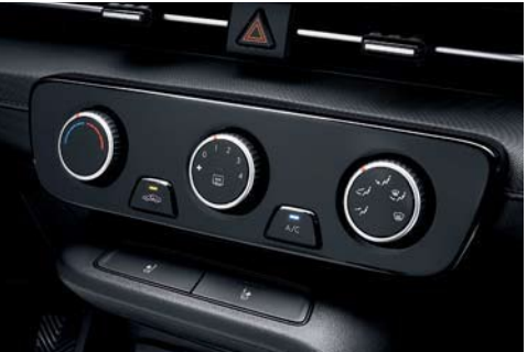
Sistema de aire acondicionado manual
